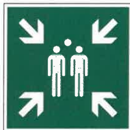
Rys. 1 Miejsce zbiórki w czasie ewakuacji 21
