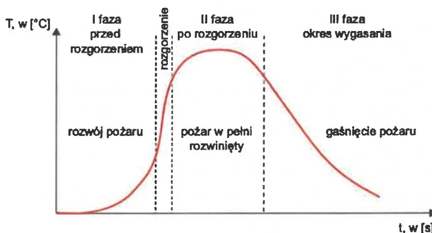
Rys. 7. Krzywa rozwoju pożaru w pomieszczeniu – średnia temperatura pożaru w funkcji czasu 14
